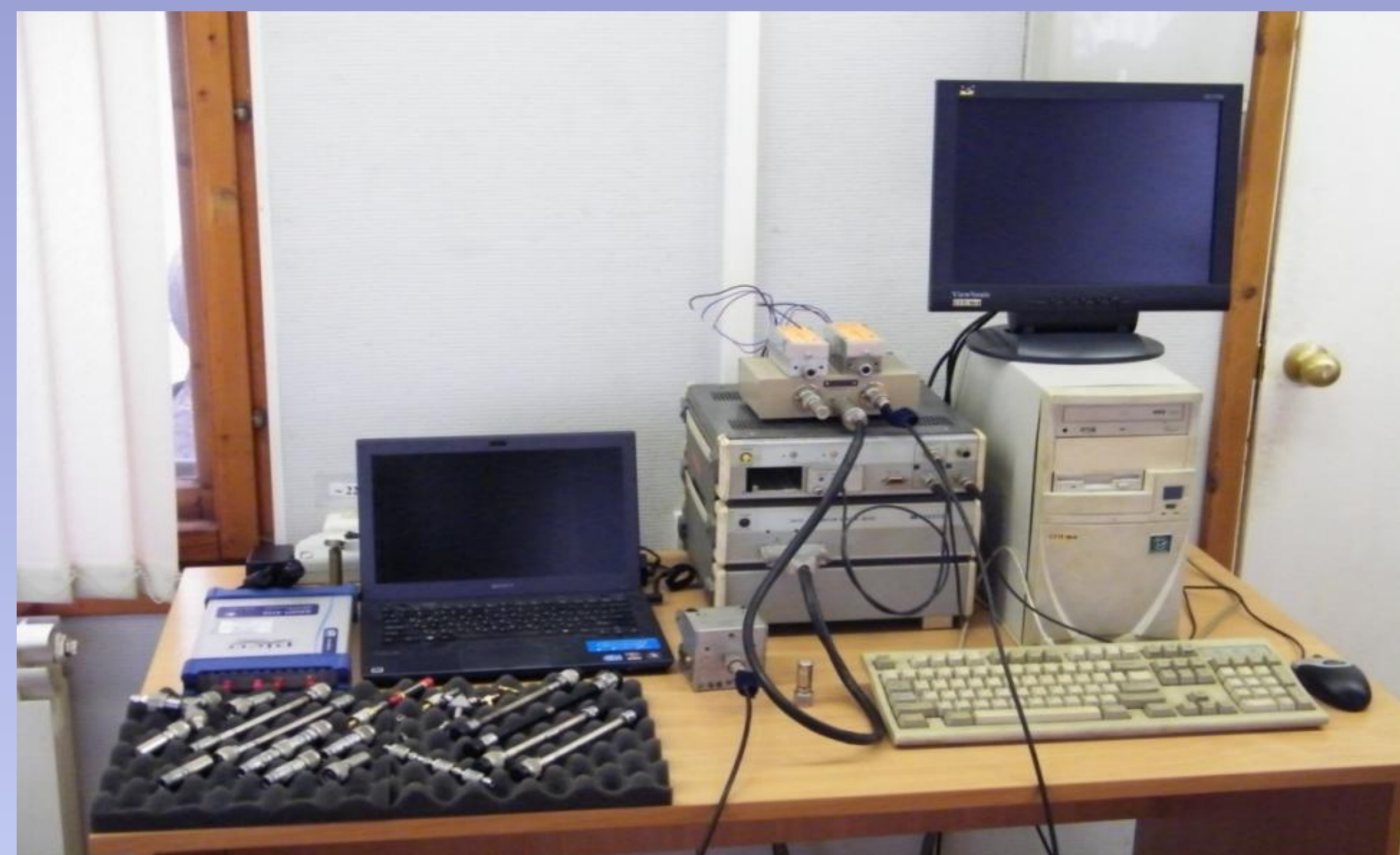
Рисунок 1. Внешний вид рабочего места антенных и фидерных измерений
