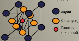
Рисунок 1. Структура элементарной ячейки BZT
