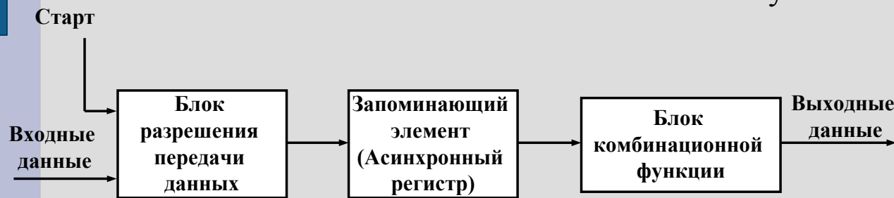
Рис.1 Взаимодействие функциональных блоков в асинхронной схеме
