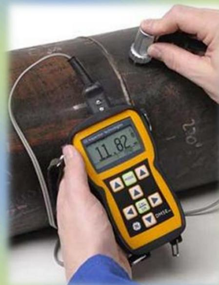
В такой сфере как толщинометрия и дефектоскопия точность высокая играет очень важную роль. Поэтому перед использованием прибора он должен пройти обязательную метрологическую поверку. Поверкой является совокупность операций, с целью, определения и подтверждения соответствия средств измерений установленным техническим требованиям.
