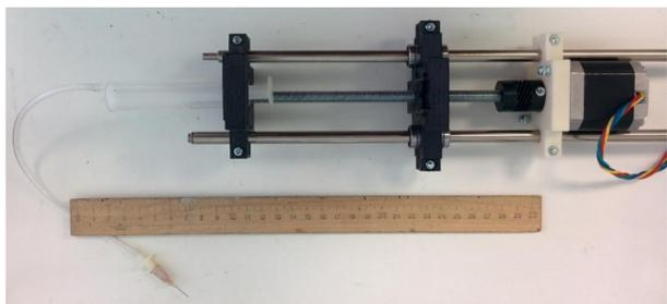
Перемещение поршня шприца осуществляется винтовой передачей, которая преобразует вращательное движение в поступательное. Вал двигателя соединяется с шпилькой при помощи гибкой муфты, для предотвращения заклинивания двигателя. Подвижная часть, которая производит давление на шприц, движется вдоль направляющих, являющихся штангами с диаметром поперечного сечения 8мм.
