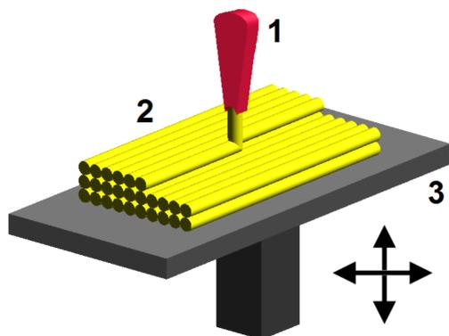
В основе всех технологических подходов к созданию объемных объектов на трехмерных принтерах лежит принцип послойного воспроизведения компьютерной модели. Экструдер перемещается в горизонтальной и вертикальной плоскостях и создаёт модель слой за слоем на платформе.
