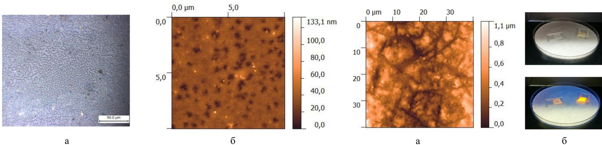
Изображения полученные в оптическом микроскопе(а) и в атомно-силовом микроскопе (б) поверхности пленки сформированной с использованием коллоидного раствора серебра
