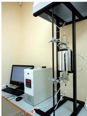
Рисунок 1 Установка газофазной модификации наночастиц
