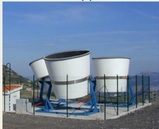
При акустическом зондировании в атмосферу излучается короткая пачка звуковых волн, которая при распространении рассеивается на акустических неоднородностях атмосферы. По времени задержки отраженного сигнала определяют дальность
