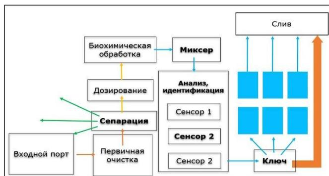
Рис. 1. Схема типичной лаборатории-на-чипе.
