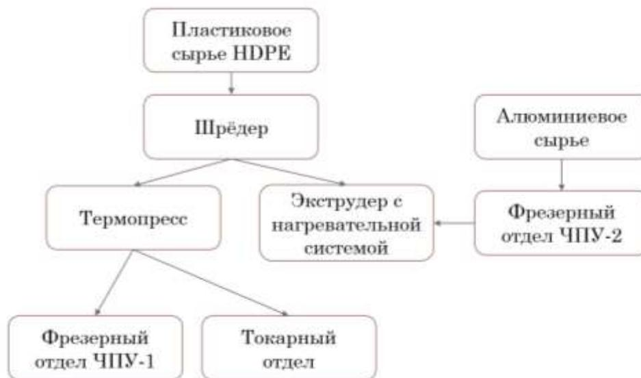
Рис 1. Технический процесс.
