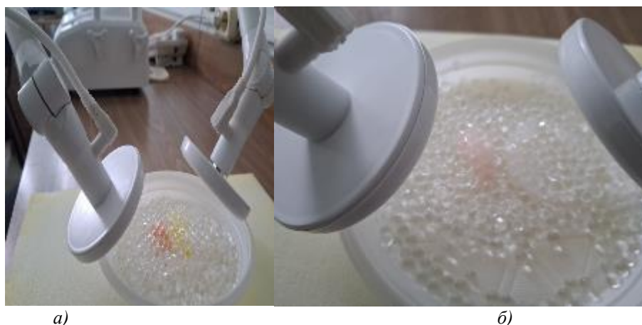
Рис. 1. Изменение цвета окрашенных термохромными пигментами силиконовых образцов в гидрогелевой среде: а) в начальный момент времени, б) через 10 минут
