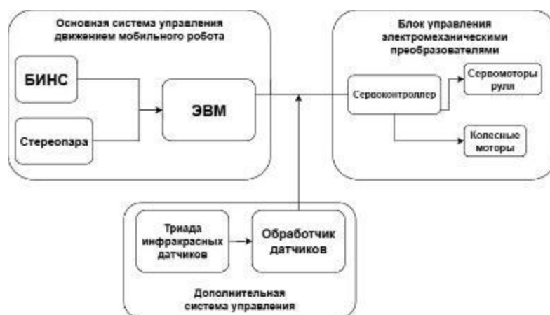
Рис. 1. Блок-схема системы управления движением мобильного робота.
