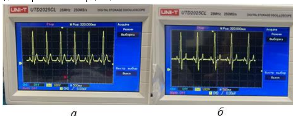
Рисунок 3. Результат генерации аддитивной модели ЭКГ (а) и модели, полученной методом воспроизведения реального кардиоцикла (б).
