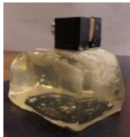
Рис.3. – Измерение скорости продольной ультразвуковой волны по схеме контроля методом поверхностного прозвучивания
