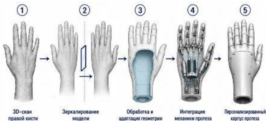
Рис. 2. Цифровой цикл персонализации протеза кисти на основе 3D-сканирования контралатеральной конечности
