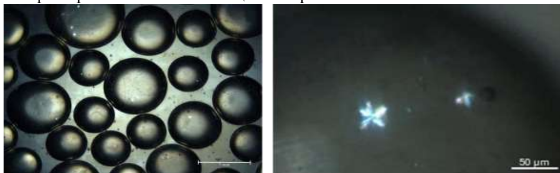
Рис. 4. Кристаллы барбитурата меламина в условиях микрофлюидного капельного синтеза, в режиме поляризационной съёмки
