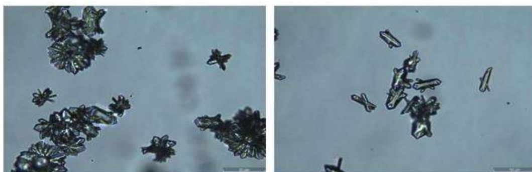
Рис. 1. Кристаллы барбитурата меламина, полученные путем синтеза в макрообъёме
