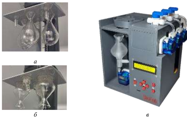
Рис. 1. Микрореактор на основе аддитивных технологий; а, б – базовая и доработанная версии микрореак-торов; в – микрореактор в системе модульного автоматизированного синтезатора BioFab
