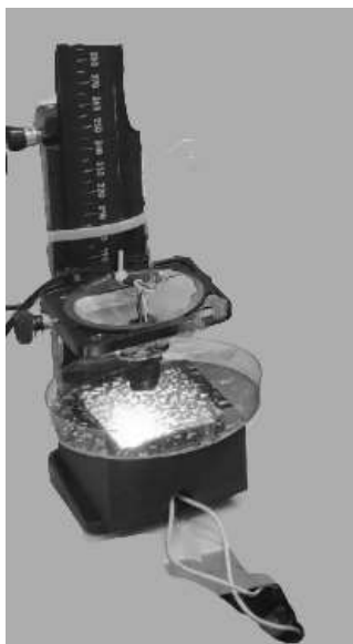
Рис. 2. Исследование жизнеспособности культур дрожжей. 1 – работающее устройство; 2 – анализируемое изображение, полученное с помощью системы РнЧ.
