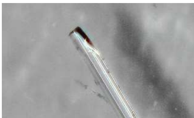
Рис. 3 Микрофотография торца волокна с дефектом формы при избыточной скорости сканирования (95%)
