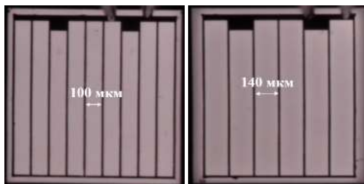
Рис. 2. Карты электролюминесценции ФЭП ЛИ (200 мА)
