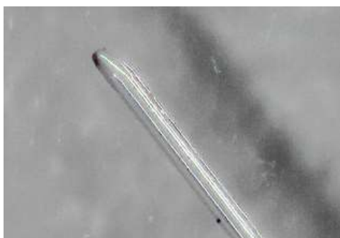
Рис. 4 Микрофотография торца волокна при скорости сканирования 65%
