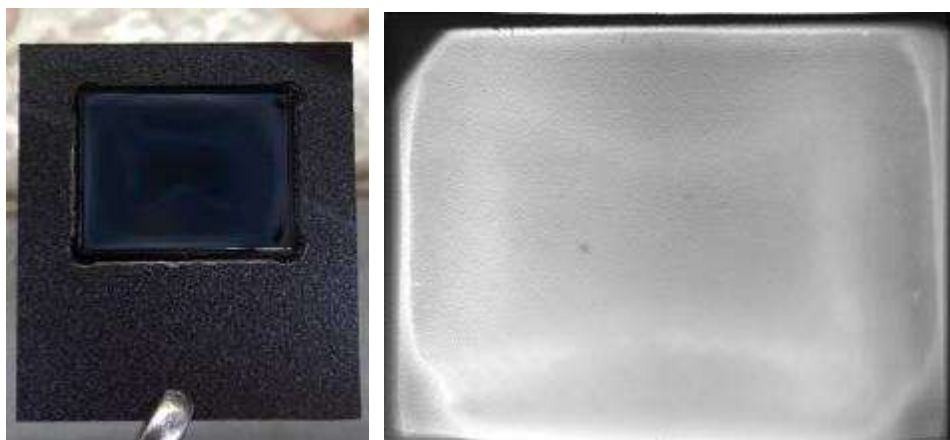
Рис.2. Пленка на поверхности мембраны: фото мембраны (слева) и полученное с помощью данной матрицы изображение (справа)
