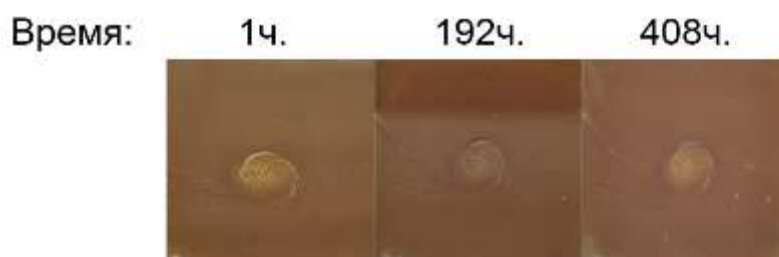
Рис. 2. Деградация плёнки с течением времени
