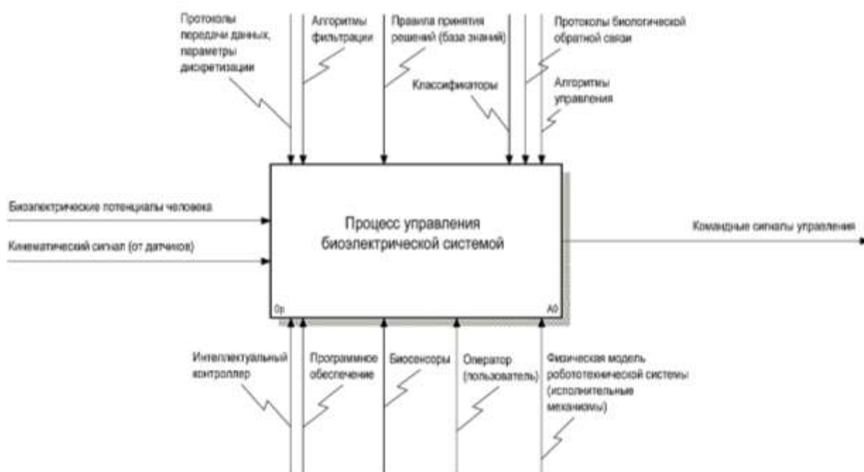
Рис. 1. Контекстная диаграмма A-0 процесса управления биоэлектрической системой
