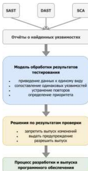
Рис. 2. Встраивание модели обработки результатов тестирования в процесс разработки программного обеспечения
