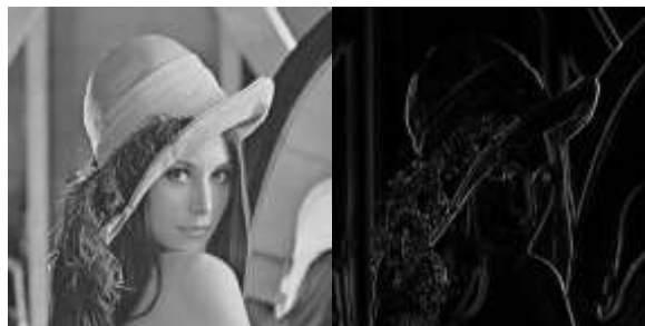
Рис. 3. Пример результата фильтрации изображения оператором Собеля по оси X
