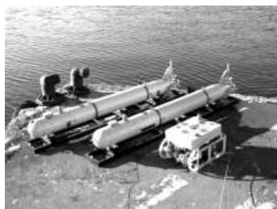
Рис. 1. Роботизированный комплекс охраны водного района «Галтель»
