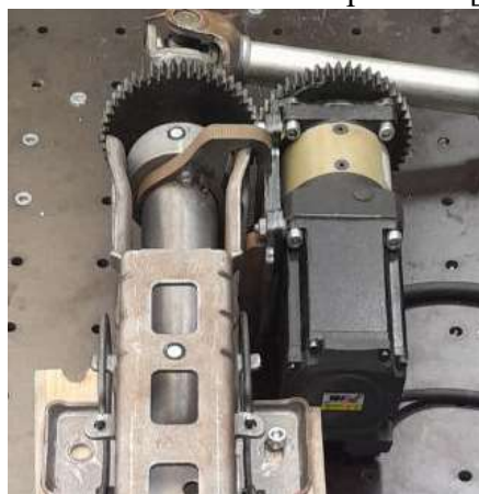
Рисунок 7. Крепление рулевого привода
