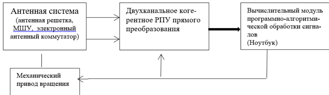
Рисунок 1 – Структурная схема пеленгатора сигналов БПЛА
