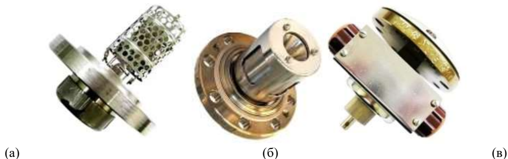
Рис.2. Внешний вид манометров для глубокого и сверхглубокого вакуума, и их диапазоны значений: (а) ПММ-27 10 \div 2 \times 10^{-8} Па ( 7.5 \times 10^{-2} \div 1.5 \times 10^{-10} Торр); (б) ПММ-32 10^{-1} \div 10^{-7} Па ( 10^{-2} \div 10^{-9} Торр); (в) ПММ-46 10^{-1} \div 10^{-11} Па ( 10^{-3} \div 10^{-13} Торр)
