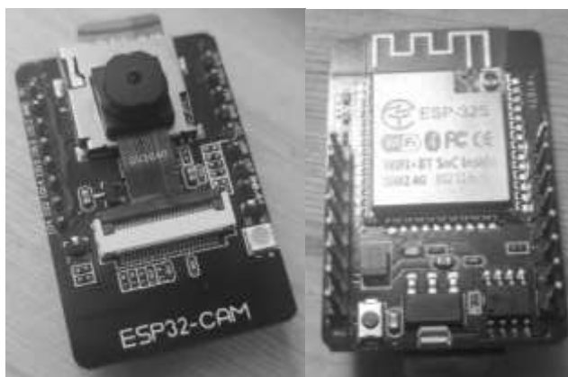
Рис. 1. Микроконтроллер ESP-32S, распаянный на плате модуля ESP32 AI THINKER
