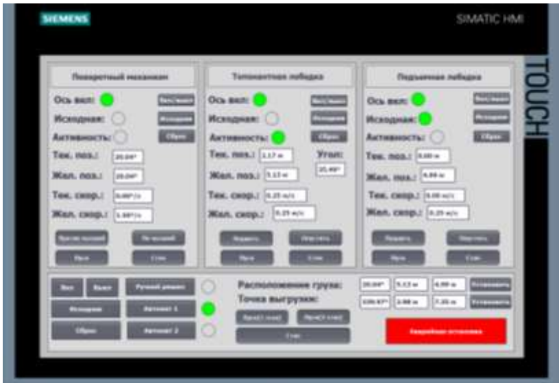
Рис. 2. Панель оператора HMI
