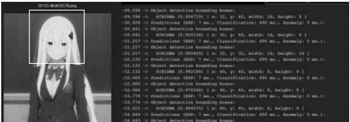
Рис. 5. Пример распознавания изображения камерой: слева – изображение, на которое ESP32 направлена, справа – COM-порт с отладочной информацией
