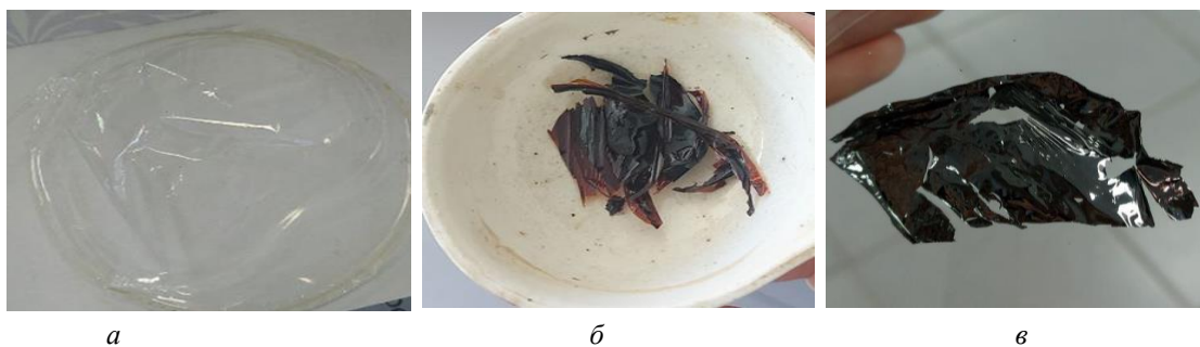
Рис. 1. Образец на различных этапах обработки: а – получение пленки, б – термическая обработка в атмосфере, в – пиролиз образца
