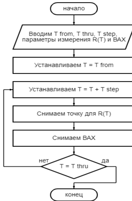
Рис. 3. Блок-схема программы I-V-T-Keysight для измерения ВАХ в диапазоне температур
