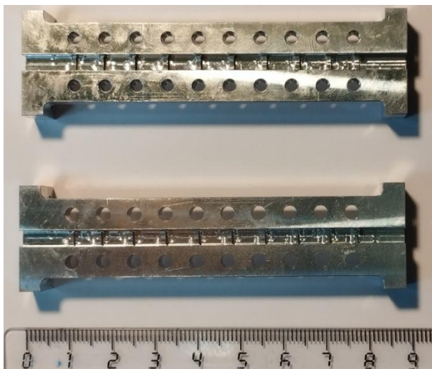
Рис. 1. Изготовленные детали волноводного ППФ диапазона 28 ГГц
