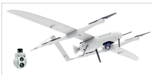
Рис. 3 . БВС типа VTOL, оснащенный гиростабилизированной камерой наблюдения
