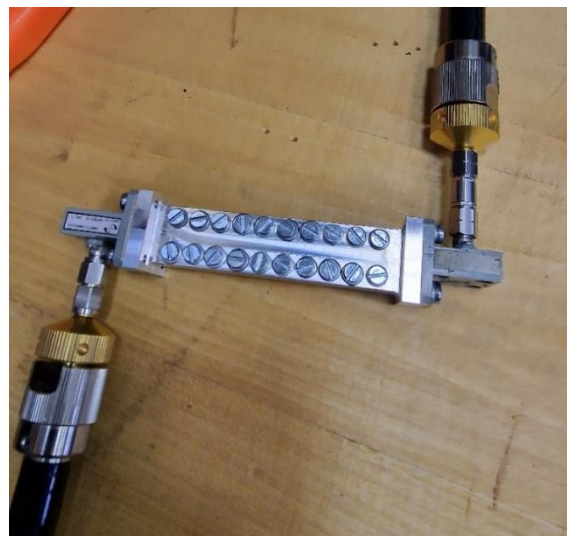
Рис. 2. Собранный макет фильтра с КПВ
