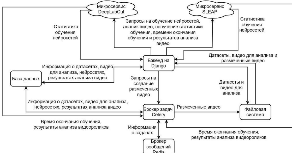
Рисунок 6. Архитектура основного веб-приложения
