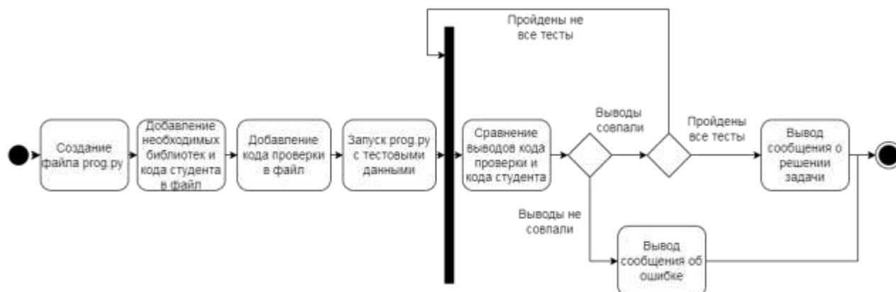
Рис. 1. UML диаграмма алгоритма проверки
