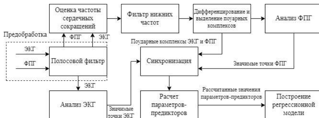
Рис. 1. Структурная схема алгоритма косвенной оценки артериального давления
