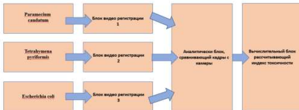
Рис. 2. Блок-схема предлагаемого аппаратного метода модульной системы определения токсичности.
