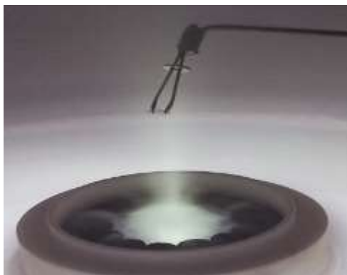
Рис. 2. Фотография процесса плазменной обработки поверхности подложки.
