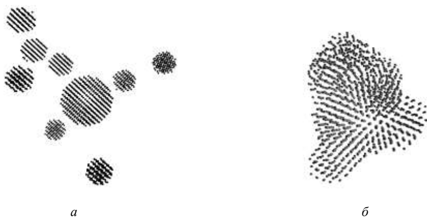
Рис. 1 Моделирование агрегации наночастиц меди: начальное (а) и конечное (б) положение частиц в системе [7]
