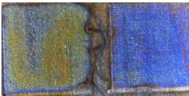
Рис.2 Обработка поверхности металла заливкой плотностью 80 л/мм на исходном режиме (слева) и на ускоренном (справа)
