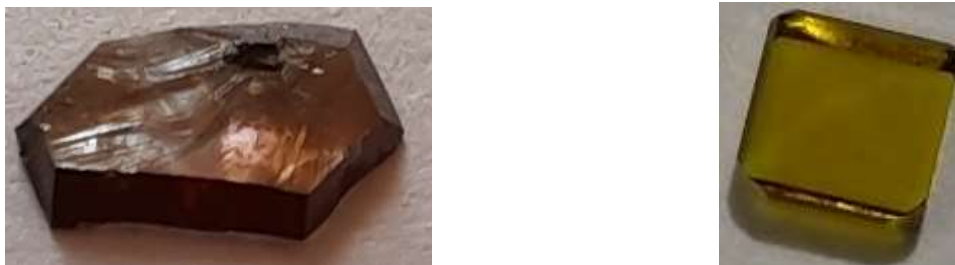
Рис. 2 – Пластина 1, сколота по направлению [111] из монокристалла алмаза (а), пластина 2 вырезана из монокристалла
