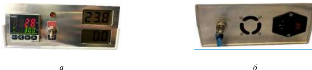
а – передняя панель модуля, б задняя панель модуля Рис. 2. Модуль контроля и управления температурой
