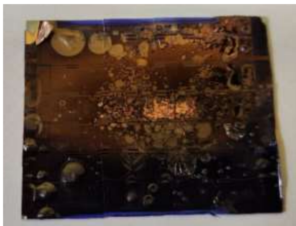
Рис.3. Образец с вспучившимся слоем фоторезиста
