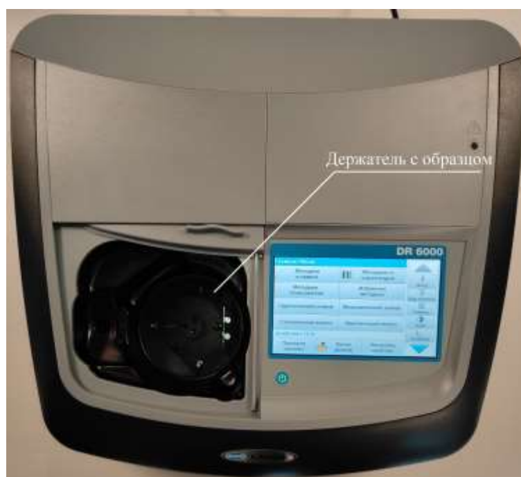
Рис. 2. Спектрофотометр DR 6000 с держателем внутри камеры для измерений.
