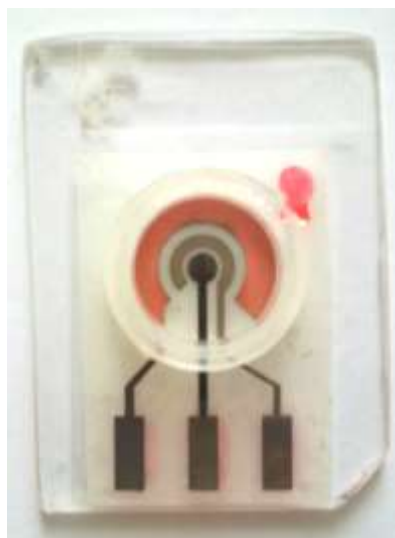
Рис. 2. Электрохимический сенсор с трехэлектродной системой.
