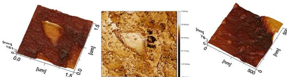
Рис. 2. АСМ изображения, различного масштаба \text{Por-Si} с нанесением 20 слоев покрытия на основе ZnO.
