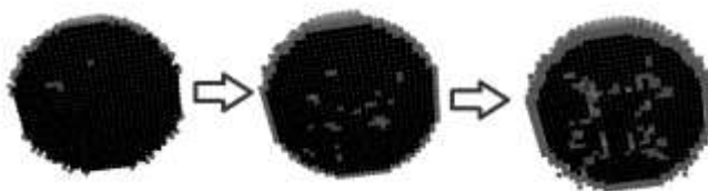
Рис. 3. Начальная стадия процесса получения наноструктурированных зерен халькогенида свинца.
