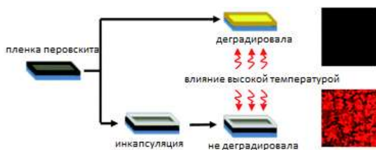
Рис. 1. Влияние высокой температуры на плёнку перовскита.
