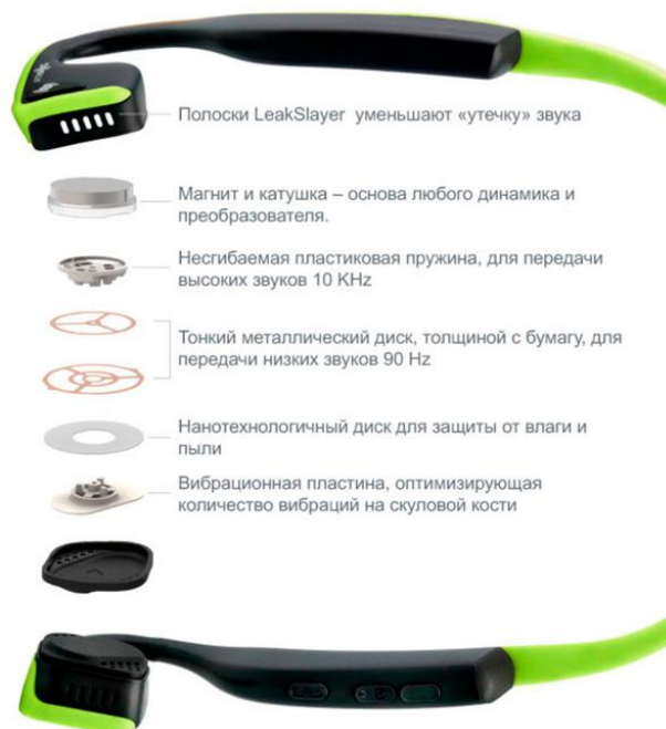
Рис.4 Внутреннее строение наушников костной проводимости
