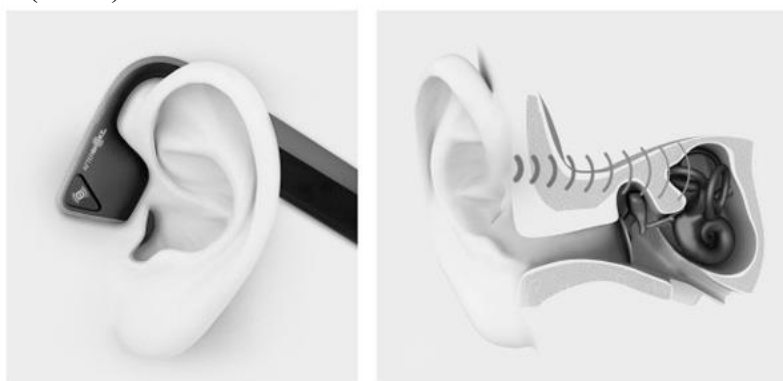
Рис.3 Принцип работы наушников костной проводимости
