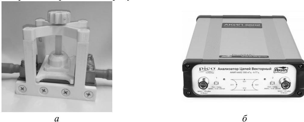
Рис. 2. Оборудование и оснастка для измерения коэффициента поглощения: а – измерительная ячейка на основе копланарной линии передачи, б – векторный анализатор цепей АКИП-6602.
