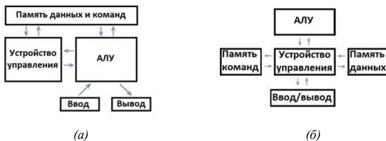
Рис. 2. Общее устройство микроконтроллера гарвардской архитектуры (а) и архитектуры фон-Неймана (б)
