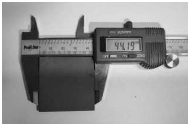
Рис. 1. Образец листового поглотителя.
