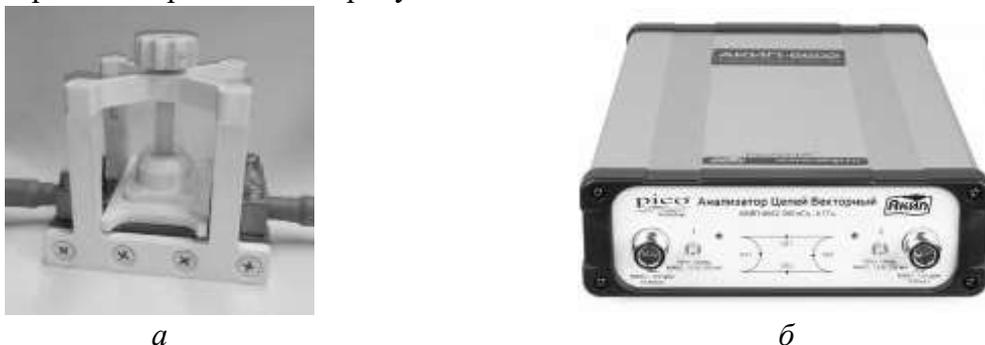
Рис. 2. Оборудование и оснастка для измерения коэффициента поглощения: а – измерительная ячейка на основе копланарной линии передачи, б – векторный анализатор цепей АКПП-6602.
