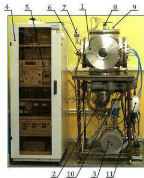
Рис. 1. Установка ВУП-11М: 1 – вакуумная камера; 2 – турбомолекулярный насос; 3 – спиральный насос; 4 – стойка управления; 5 – контроллер ПИС; 6 – магнетрон, 7 – датчик давления; 8 – ввод вращения; 9 – клапан напуска атмосферы; 10 – затвор; 11 – проточный нагреватель
