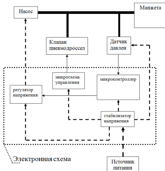
Рис 1. Система нагнетания воздуха в манжету.
