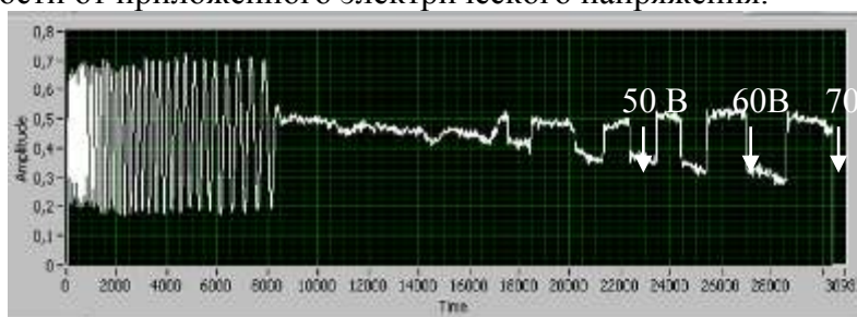
Рис. 2 Интерферограмма, полученная при подаче электрического напряжения на мембрану из нитрида кремния с металлическими электродами
