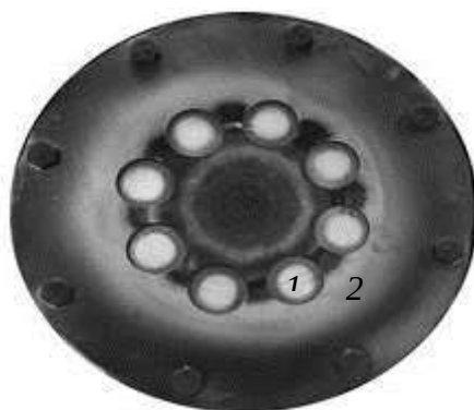
Рис. 2. Фото магнетрона с сэндвич-мишенью: 1 – электроды; 2 – мишень
