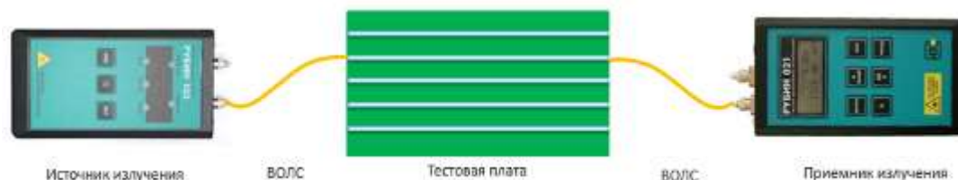
Рисунок 5 – Схема измерения тестовой платы
