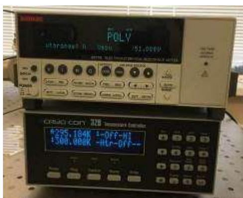
Рисунок 2. Сверху - электрометр-измеритель больших сопротивлений (Keithley 6517B); снизу – температурный контроллер (Cryo-con Model 32b)
