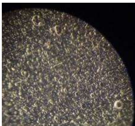
Рис. 2. Покрытие титана, получаемое с помощью вакуумно-дуговых источников плазмы при использовании ионной, нейтральной и капельной фракции (увеличение составляет 225 крат)
