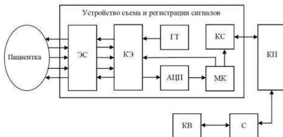
Рис. 1. Обобщенная структура системы удаленного мониторинга состояний плода на основе метода электроимпедансной томографии
