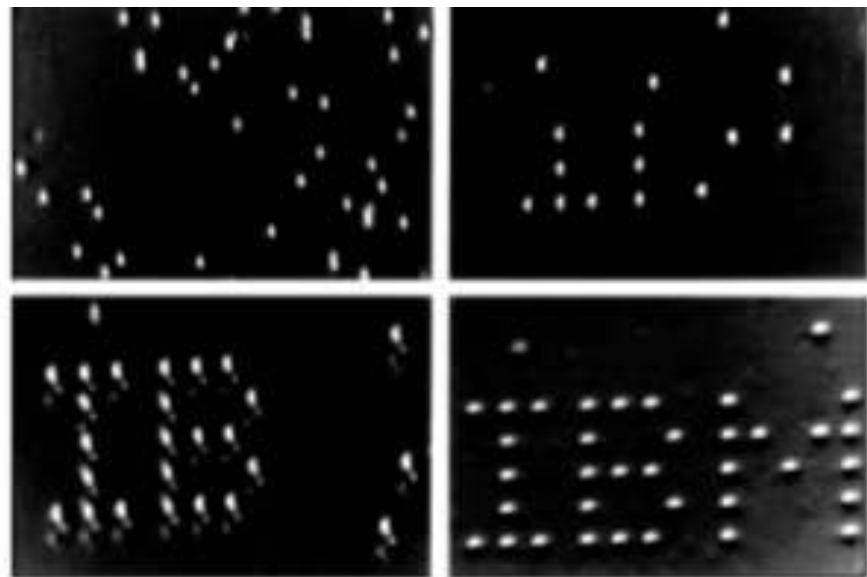
Рис. 5.14. а) СТМ изображения, отображающие последовательность перемещения атомов Хе; б) 3-мерное изображение логотипа, расстояние между атомами
