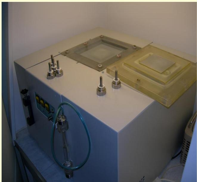
Внешний вид установки для модификация поверхности материалов обработкой в плазме низкотемпературного объемного разряда
