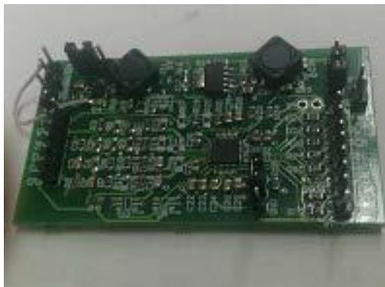
Рис. 1. Отладочная плата на базе AFE ADS1292R
