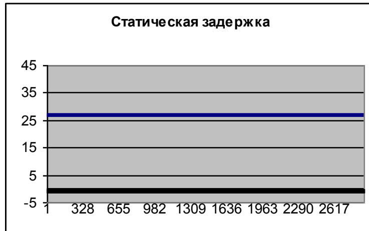
Рисунок 2. График зависимости статической задержки горения зеленого цвета светофора в течение суток
