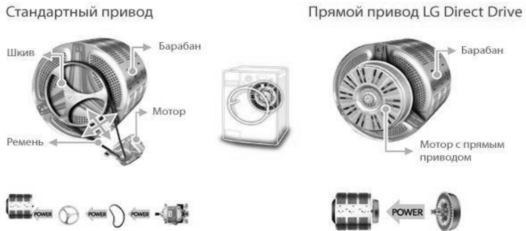
Рис.1. Прямой привод стиральной машины LG [3]
